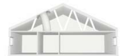
VELUX valotunneli asennetaan välikaton läpi.
